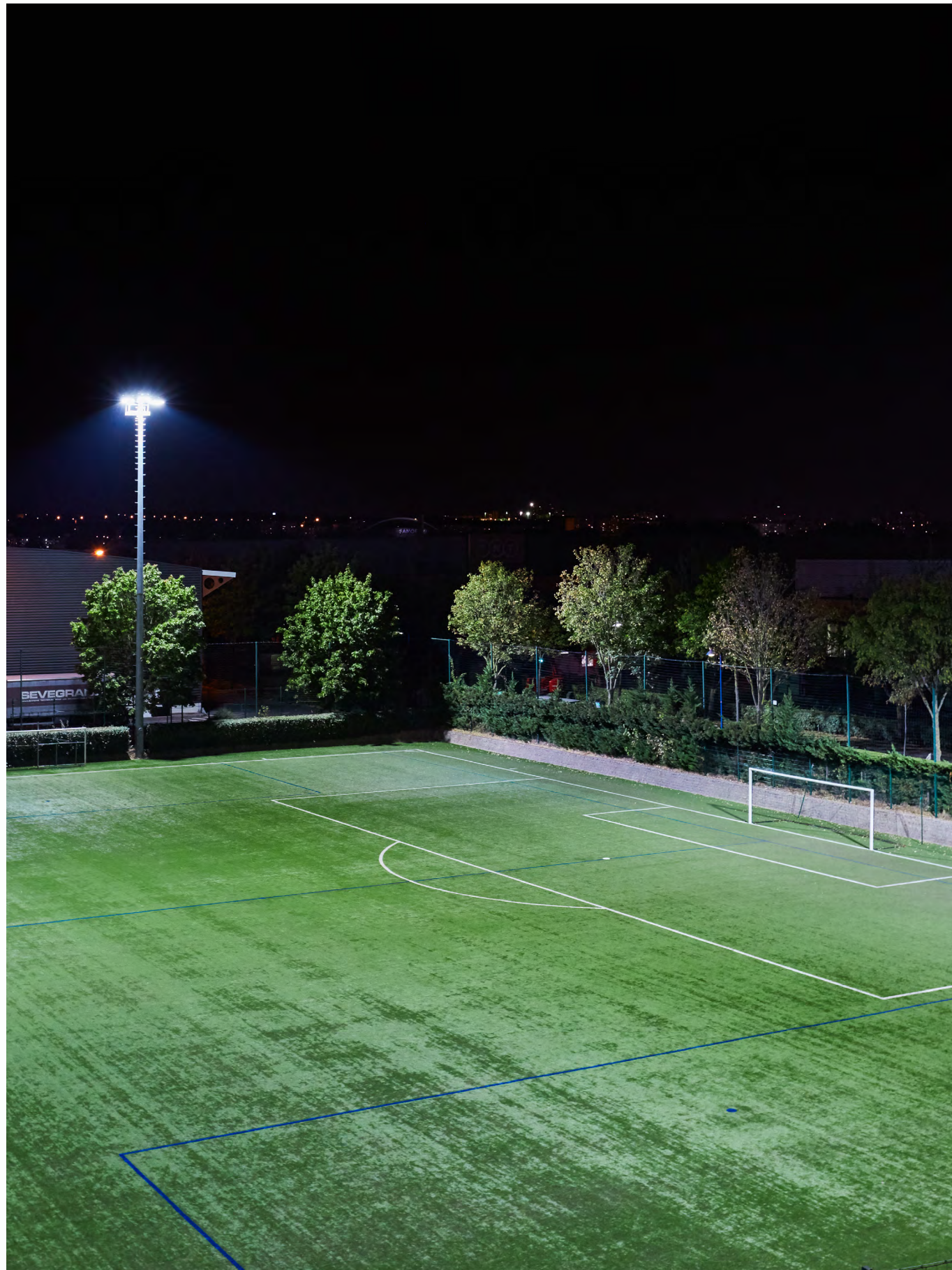
Alfortville, Frankreich / R-System gen3 MAX / Normgerecht laut französischem Fußballnationalverband / 150 lux, U_o > 0,7 , E_{min}/E_{max} > 0,4 / 2020
